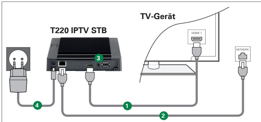
Abbildung 1 - Kabelverbindungen
